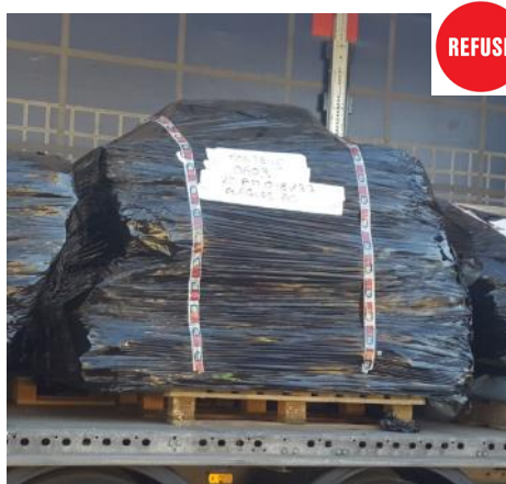
Palette trop haute : risque au déchargement (1m de hauteur maximum)
